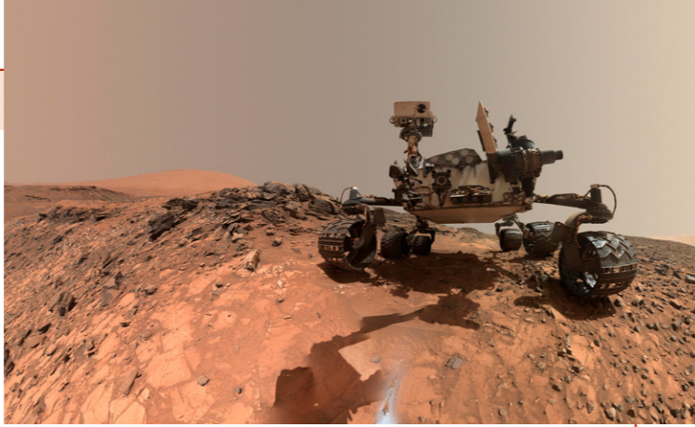
【図1】火星探査車キュリオシティ。2012年の着陸以降、数多くの写真や、周辺の堆積物の化学・鉱物データ等を地球に送り届け続けている。撮影地点付近で採取したドリルコアがシリカに富むことが近年報告された。（出典：NASA/JPL）
