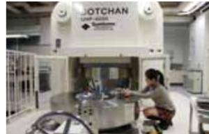
GRCの世界最大の超高压合成装置BOTCHAN-6000。6000トンの力を加えることができ、大容量の試料に最高25万気圧で約3000°Cの高压高温環境を実現できる。その名は、新物質合成を目指そうという英文の略称であるほか、夏目漱石『坊っちゃん』の舞台が愛媛大学のある松山であることにも由来する。
