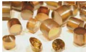
通常のダイヤモンドよりも硬い「ヒメダイヤ」。GRCが世界に先駆けて超高压下で合成に成功した、ナノサイズのダイヤモンド結晶が集まった多結晶で、企業から製品化されるとともに超高压実験など様々な応用が開始されている。
